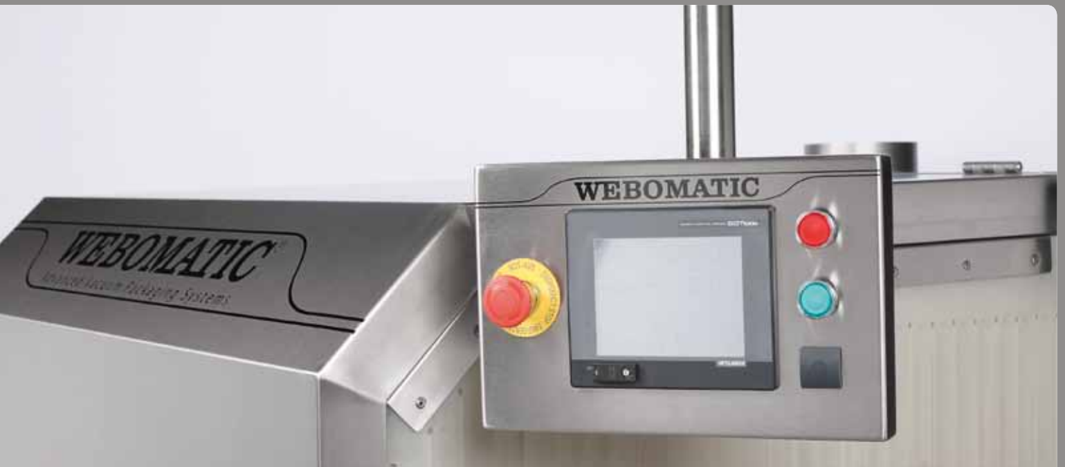
Touchscreen beim Schrumpftunnel STCW.
