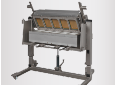
Werkzeugwechselwagen (optional) für bequeme Formatwechsel und sichere Werkzeug-Aufbewahrung
